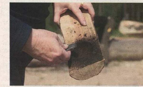
Falon päälle aseteltu hillos polttaa puusta osan pois, jonka jälkeen puuta on helppo käsitellä. Tapa on helpotanut puuesineiden muovaamista, kun käytössä on ollut luonosti työkaluja.
